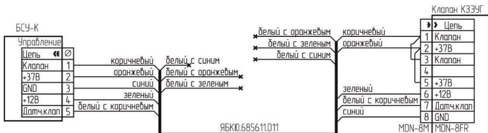
Рисунок Б.5 – Схема подключения клапана КЗЭУГ с разъемом MDN8FR.
