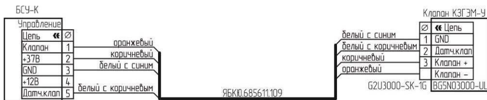
Рисунок Б.4 – Схема подключения клапана КЗГЭМ-У с разъемом BG5NO3000-UL.
