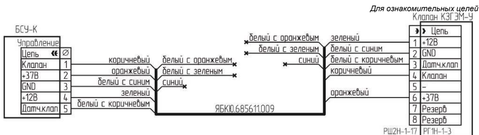
Рисунок Б.3 – Схема подключения клапана КЗГЭМ-У с разъемом РГ1Н-1-3.
