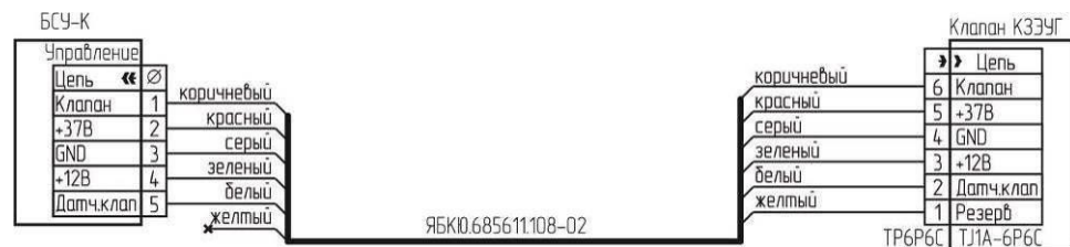
Рисунок Б.6 – Схема подключения клапана КЗЭУГ с разъемом TJ1A-6P6C.
