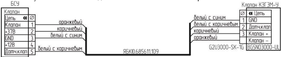
Рисунок А.5 – Схема подключения клапана КЗГЭМ-У с разъемом BG5N03000-UL.
