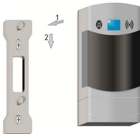
Рисунок А.3 – Установка блока на монтажную панель
