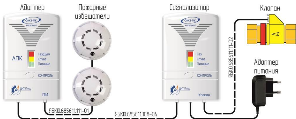
Рисунок Б.2 – Типовая монтажная схема подключения пожарных извещателей
