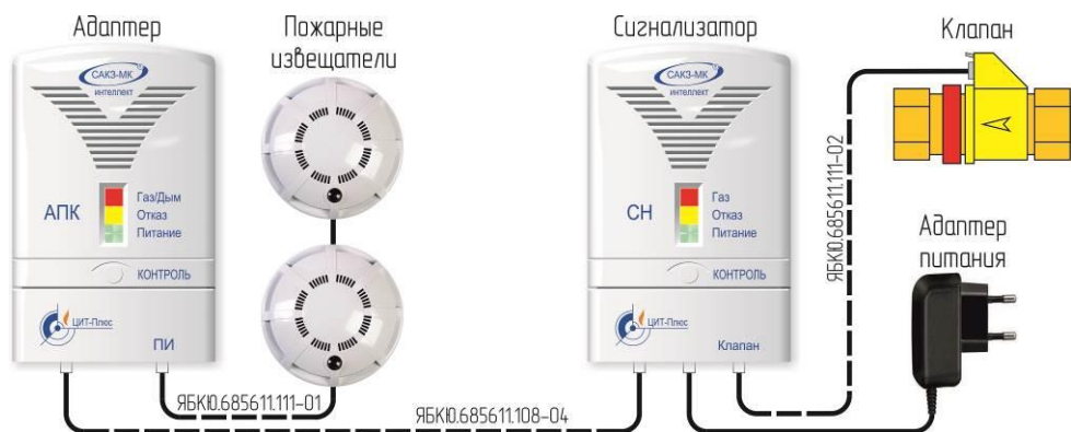
Рисунок Б.2 – Типовая схема с клапаном и пожарными извещателями
