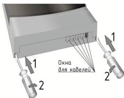
Рисунок 2 – Снятие крышки клеммного отсека
