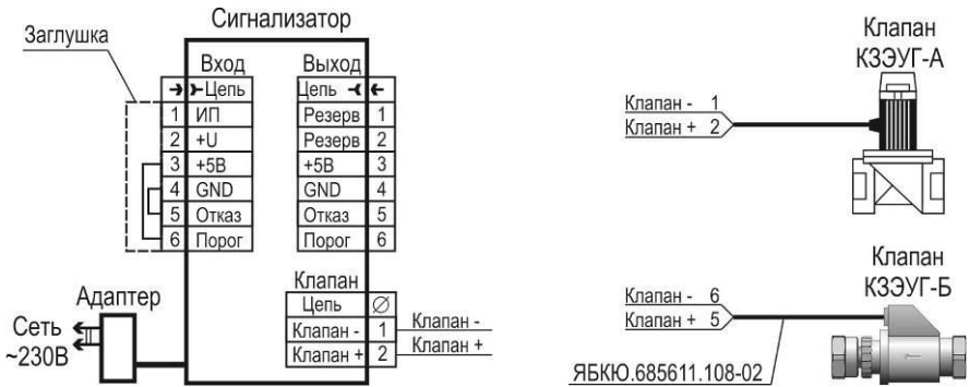
Рисунок Г.1 – Типовая схема включения сигнализатора СЗ-3-1АГ
