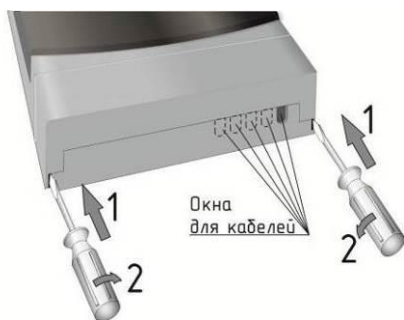
Рисунок 2 – Снятие крышки клеммного отсека
