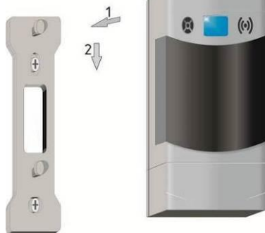
Рисунок 3 – Установка сигнализатора на монтажную панель
