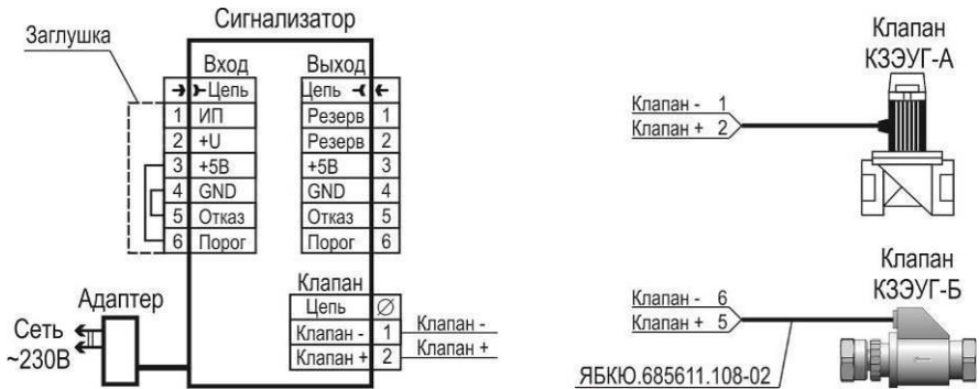
Рисунок Г.1 – Типовая схема включения сигнализатора СЗ-1-1АГ
