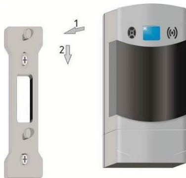
Рисунок 3 – Установка сигнализатора на монтажную панель
