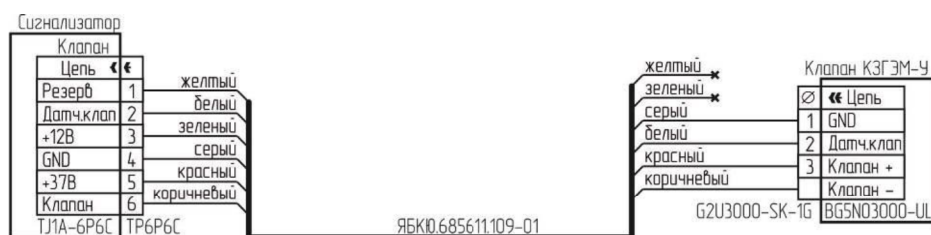
Рисунок В.8 – Схема подключения КЗГЭМ-У с разъемом ВГ5N03000-UL к сигнализатору с разъемами ТЛ1А-6Р6С.
