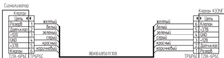
Рисунок В.9 – Схема подключения клапана КЗЭУГ с разъемом ТЛ1А-6Р6С к сигнализатору с разъемами ТЛ1А-6Р6С.
