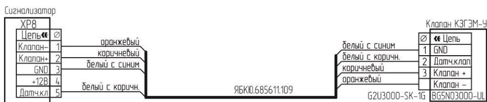
Рисунок Г.6 – Схема подключения клапана КЗГЭМ-У с разъемом BG5NO3000-UL.
