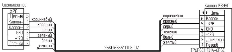
Рисунок Г.8 – Схема подключения клапана КЗЭУГ с разъемом TJ1A-6P6C.
