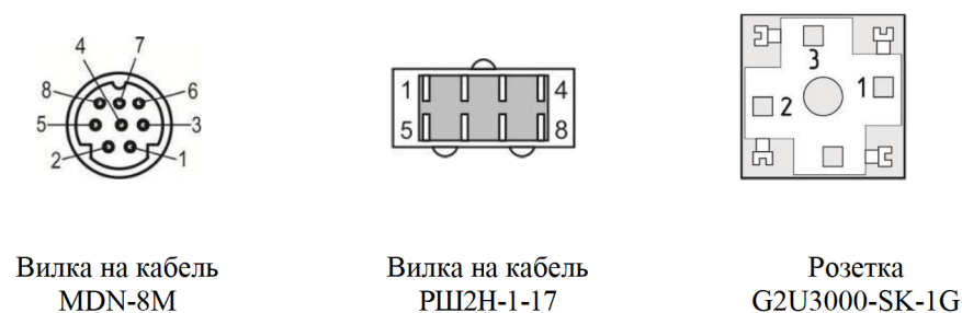
Рисунок В.6 – Нумерация контактов разъемов. Вид со стороны пайки (монтажа).
