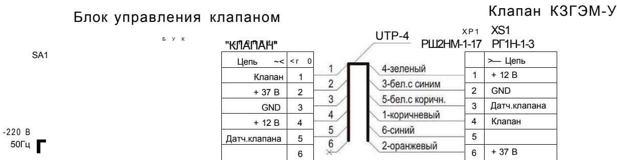
Типовая схема подключения клапана КЗГЭМ-У к блоку управления клапаном
