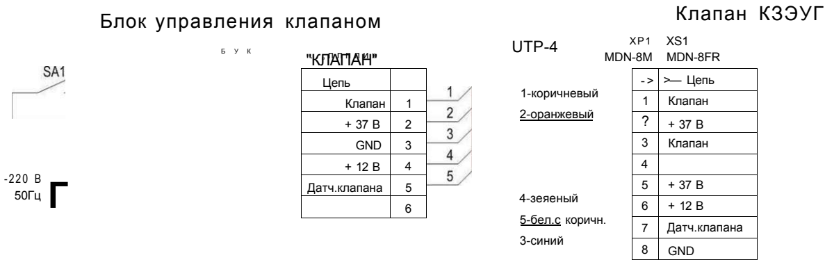
Типовая схема подключения клапана КЗЭУГ к блоку управления клапаном
